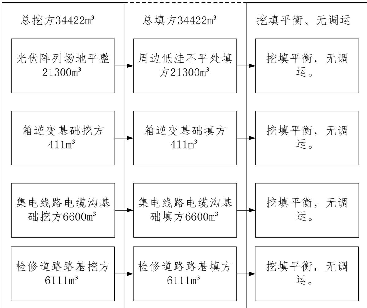
图 5 土石方平衡流向框图
